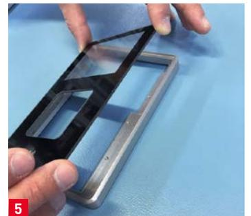
**5** Le verre est positionné et pressé sur le cadre en aluminium.
