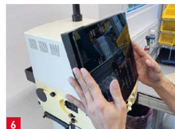
L'écran est positionné et pressé sur la plateforme d'opération Faros.
