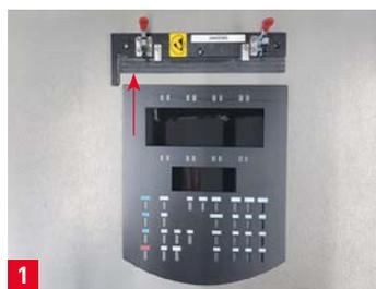
Le dos de l'écran est nettoyé avec de l'alcool isopropylique IBZ avant le collage et est positionné à fleur du guidage.
