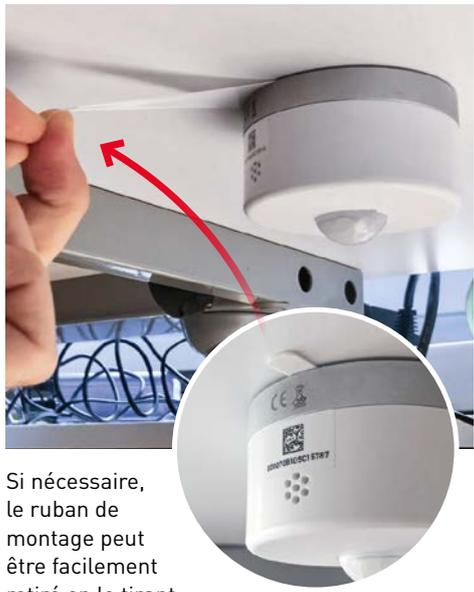
Si nécessaire, le ruban de montage peut être facilement retiré en le tirant simplement.
