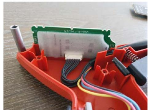
La pièce estampée est appliquée sur le circuit imprimé pour protéger l'électronique de l'humidité
