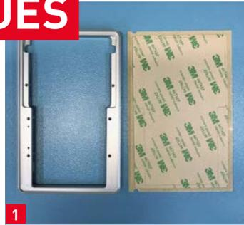
**1** Le cadre en aluminium est nettoyé avec l'alcool isopropylique d'IBZ avant l'assemblage.
