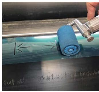
**Solution :** Une pièce autocollante de 5,9 mètres de long avec des perforations à intervalles réguliers est appliquée sur le tuyau et sert de gabarit de repérage des entretoises. On évite ainsi un
