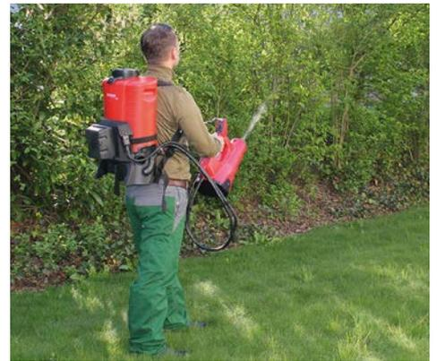
Grande efficacité sur la zone ciblée : Le flux d'air réglable et la pré pulvérisation pressurisée permettent d'atteindre de grandes portées de pulvérisation avec une perte minimale de produit en assurant un mouillage optimal et une très bonne pénétration au sein du feuillage ou de la végétation.
