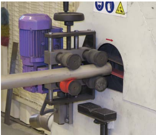
Rohre werden mit IBZ-Schleifmitteln geschliffen.
