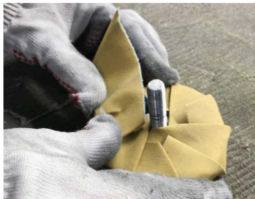
«Tampon» wird für den Schleifvorgang vorbereitet
