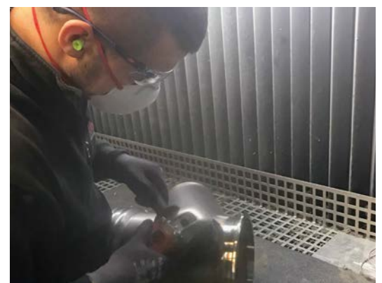
Schutzbrille, Atemschutzmaske, Gehörschutz und Handschuhe schützen beim Schleifen
