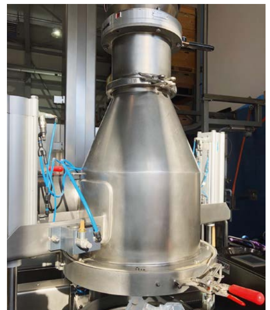
Perfekt geschliffene Schweissnähte bei einer Abfüllanlage
