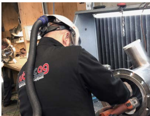
3M Adflo Atemsystem schützt beim Polieren mit dem Fein Compact Winkelschleifer
