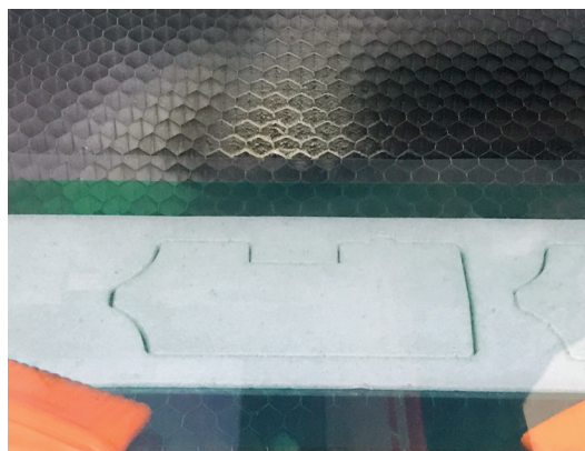
Einseitiges Extrem-Dichtband wird auf Rollen lasergeschnitten
